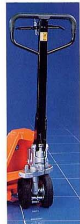
Bremsvorrichtung parking and travelling brake frein de parking et de service freno de aparcamiento
